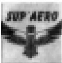
Figure 7.1-1 Image produite par l'APS 32x32 PD @250kpx/s
